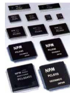
PCL系列 电机控制用脉冲LSI
